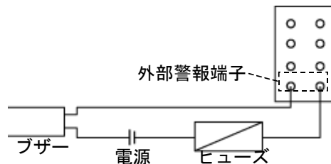
外部警報端子への配線(通電が2A未満の場合)
